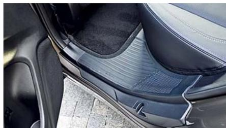
На порогах задних дверей установили массивную пластиковую подножку. На нее можно вставать, когда крепишь груз на крыше.
