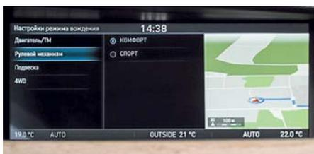
В режиме *Individual* можно менять настройки шасси и силового агрегата.
