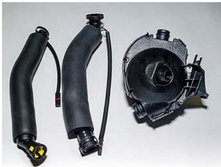
Неисправности системы вентиляции картерных газов – еще одна возможная причина повышенного расхода масла. Неизбежные отложения со временем значительно снижают производительность маслоотделителя и сокращают ресурс управляющего клапана вентиляции или вынуждают его работать некорректно. В результате во впускной воздушный тракт попадает гораздо больше жидкого масла; оно сгорает в цилиндре, оставляя после себя нагар на поршнях и клапанах.
