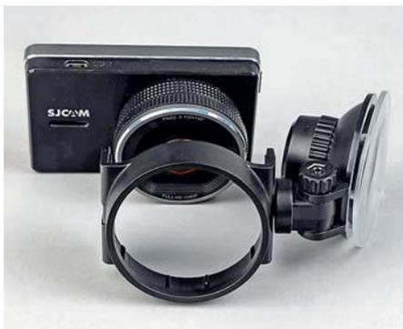
У прибора SJcam SJdash оригинальное крепление – через переходную рамку, в которую просовывается объектив регистратора.
