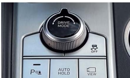
Поворотной шайбой выбираешь один из ездовых режимов – *Normal* или *Sport*. В каждом электронные ассистенты работают по особому алгоритму, но ощутимой разницы мы не заметили. Рядом – кнопка отключения ESP.
