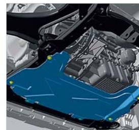
Пластиковый щит под двигателем – это скорее пыльник, нежели защита. Однако и он всё же лучше, чем ничего.
