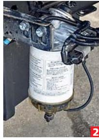
На HD78 и HD120 появилось два топливных фильтра. Основной **1** – на силовом агрегате, фильтр предварительной очистки топлива **2** закреплен на раме. Оба – с обогревом. Это обеспечивает дополнительную защиту от низкокачественного топлива.
