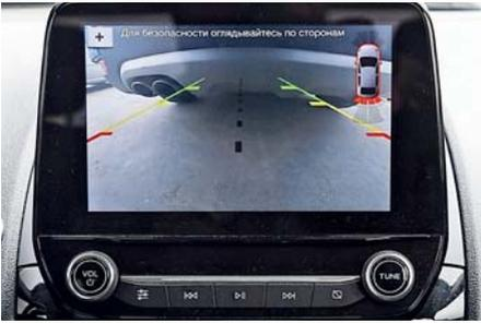
Маневрируя в тесных дворах, нужно постоянно помнить про запаску на пятой двери. Камера заднего вида, как и датчики парктроника, расположена на бампере под кофром, а красные метки на проекции изображения с камеры не совпадают с реальным положением запаски.
