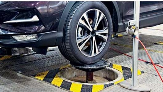
Вибростенд в Крэнфилде может имитировать езду по дорогам любого типа и является своего рода лакмусом для элементов кузова и деталей интерьера. После стеновой протряски автомобиля демонтируют переднюю панель салона и при помощи эндоскопа осматривают ее внутренние полости. Так устраняются потенциальные «сверчки» и другие проблемы.
