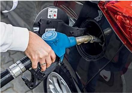
Горловина без крышки (Easy Fuel) облегчает процесс заправки. Однако в жаркую погоду при резком нажатии заправочным пистолетом на клапан есть риск быть обрызганным топливом – при заправке лучше стоять чуть сбоку.
