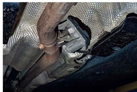
Клапан регулировки давления выхлопных газов – уязвимое место дизельной машины.
