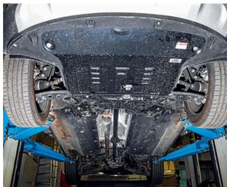
Под металлической защитой мы обнаружили пластиковый пыльник. Архитектурой шасси Sorento Prime напоминает Santa Fe. Но есть и отличия: поворотные кулаки, например, здесь из стали, а не из алюминия.
