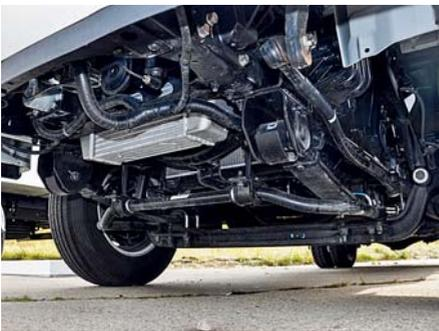
Передняя подвеска HD35City зависимая, с мощной балкой и стабилизатором поперечной устойчивости.
