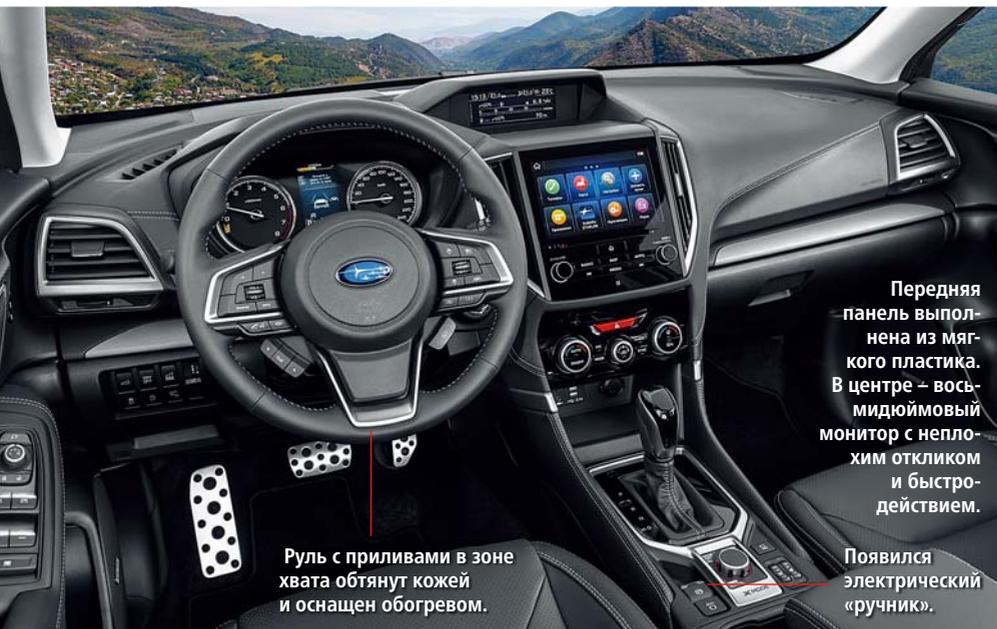
Руль с приливами в зоне хвата обтянут кожей и оснащен обогревом.
