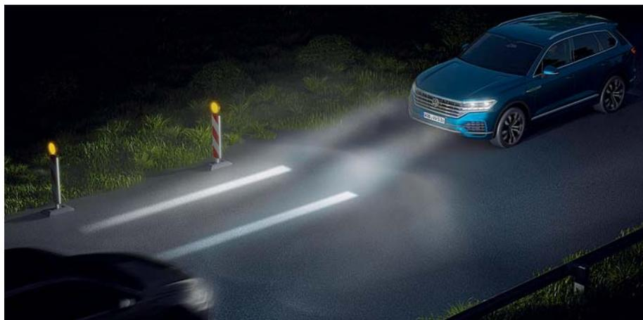
Многопиксельные фары могут проецировать на асфальт сложные изображения. Одна из самых банальных функций – линии-подсказки, показывающие ширину машины. Напоминают траектории на экране камеры заднего вида.
