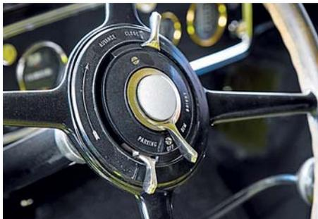
Размещать органы управления на руле придумали не вчера. Здесь – рычажки управления наружным освещением, опережением зажигания и дроссельной заслонкой.
