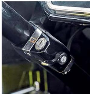
Зажигание включали рычажком, а ключом фиксировали этот рычаг и запирали рулевую колонку.
