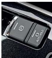
На все полноприводные версии теперь ставят электромеханический стояночный тормоз.
