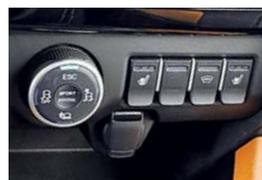
Обогрев передних сидений – трехступенчатый. Его интенсивность снижается по мере прогрева. Рядом – шайба выбора режимов движения Lada Ride Select.
