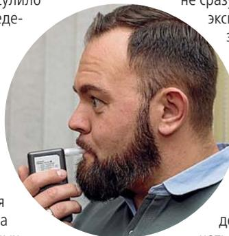
В течение десяти секунд прибор специализируется, после чего требует продувки, которая сопровождается негромким писком. Щелчок означает, что проба воздуха взята.
