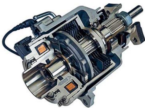
Вне зависимости от типа полноприводной трансмиссии (AWC или S-AWC) подключением задней оси ведаёт электромагнитная муфта, которая не блещет быстродействием. Вне асфальта лучше заранее ее заблокировать, благо такая возможность есть.
