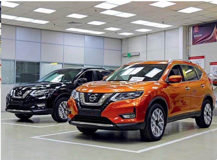
Так выглядит комната проверки автомобиля по стандарту AVES, насчитывающему более пятисот параметров. Автомобиль выдергивают с конвейера случайным образом. Полная инспекция занимает семь часов. Обратите внимание на потолочные светильники. Их расположение рассчитано специальной программой и помогает обеспечить оптимальное освещение.
