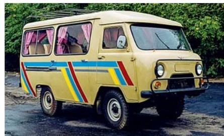
↑ Для мелких заводов разработали типовую конструкцию ТС-17144А, которую с небольшими изменениями воспроизводили на шасси УАЗ несколько заводов, в том числе Кирсановский механический в Тамбовской области.
