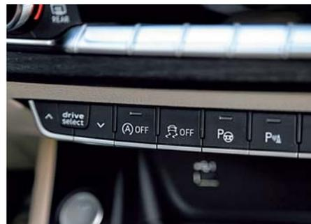
Кнопка отключения системы стабилизации Audi находится прямо на консоли. Короткое нажатие ослабляет электронный ошейник, длительное – снимает его.
