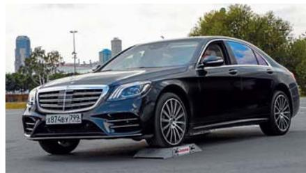
**Две платформы под заднюю ось S-класс побеждает с большим трудом, причем только с отключенной ESP. Зато с «диагональю» справляется играючи.**
