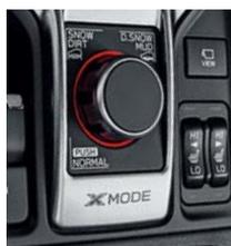
У системы X-Mode в топовой комплектации два режима работы: «снег/грязь» и «глубокий снег/глубокая грязь».
