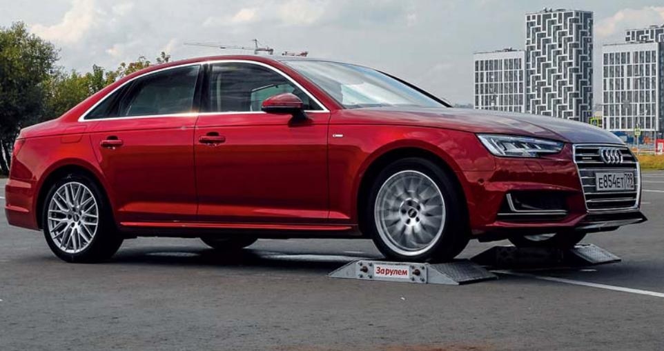
она съезжает, но соображает дольше, чем хотелось бы. Да и двигатель приходится раскручивать едва ли не до трех тысяч оборотов, а за это – штраф: минус один балл. При попытке выбраться из ловушки задним ходом та же история.
