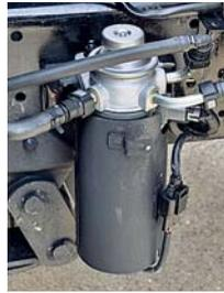
У компактного HD35City топливный фильтр один. Он тоже снабжен обогревом. Есть ручная подкачка.
