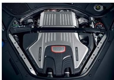
← Четырехлитровый V8 с двойным турбонаддувом – это дефорсированная версия двигателя, которым оснащается Panamera Turbo.
