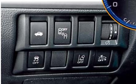
Система стабилизации Subaru отключается продолжительным нажатием клавиши слева от рулевой колонки. Режим X-Mode (XV, Forester), оптимизирующего работу двигателя, автомата и вспомогательной электроники, у Legacy нет.
