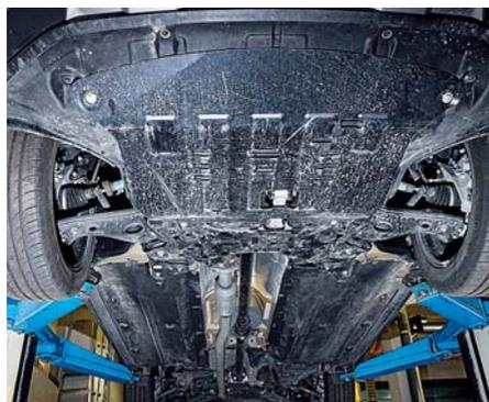
Как и у Sorento Prime, металлическая защита картера «надета» поверх пластикового пыльника. Но, в отличие от родственника, здесь межосевая муфта прикрыта прочным панцирем.
