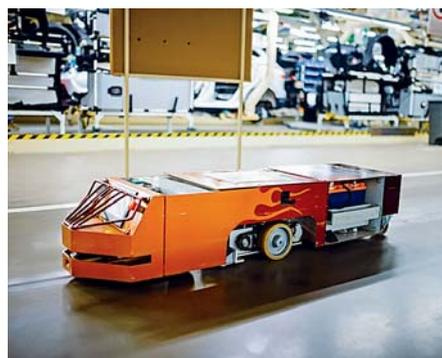
Беспилотные тележки-тягачи, напоминающие робот-пылесос, ездят вдоль магнитных линий, проложенных по полу, и подвозят контейнеры с нужными деталями. И никогда не сталкиваются.
