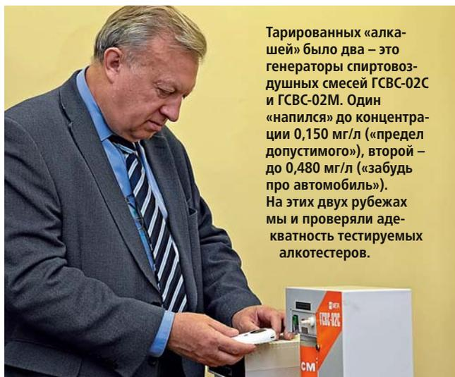
Тарированных «алкашей» было два – это генераторы спиртовоздушных смесей ГСВС-02С и ГСВС-02М. Один «напился» до концентрации 0,150 мг/л («предел допустимого»), второй – до 0,480 мг/л («забудь про автомобиль»). На этих двух рубежах мы и проверяли адекватность тестируемых алкотестеров.
