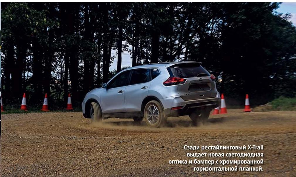
Сзади рестайлинговый X-Trail выдает новая светодиодная оптика и бампер с хромированной горизонтальной планкой.
