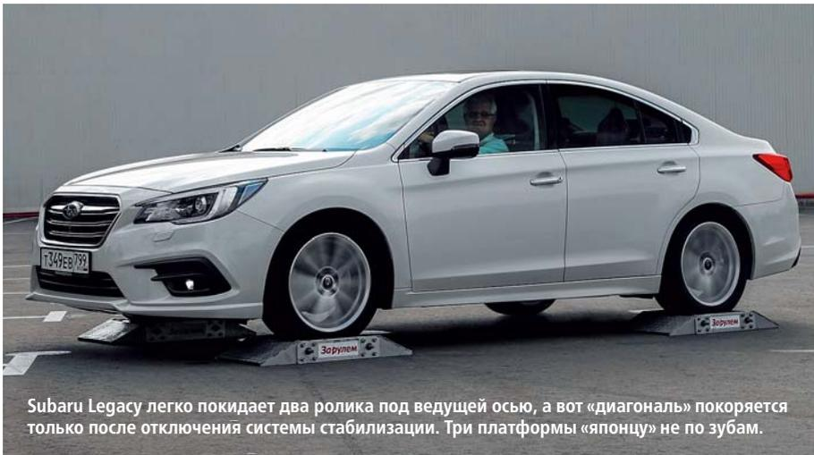
Subaru Legacy легко покидает два ролика под ведущей осью, а вот «диагональ» покоряется только после отключения системы стабилизации. Три платформы «японцу» не по зубам.
