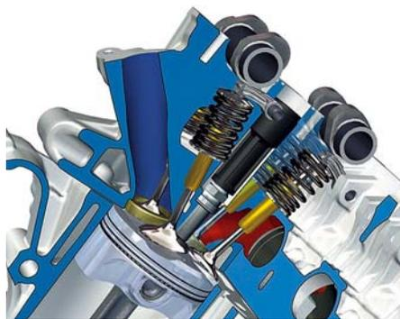
Масло попадает в камеру сгорания из-за износа направляющих втулок клапанов и их маслосъемных колпачков, которые часто еще и дубеют от старости и окончательно теряют уплотняющую функцию. При их замене важно проверить состояние направляющих втулок: повышенный люфт клапанов быстро прикончит новые маслосъемные колпачки – и масло снова потечет в камеру сгорания.
