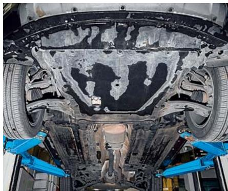
Защита двигателя пластиковая. Самая низкая точка – элементы выхлопной системы.
