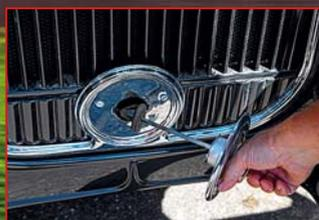
Отверстие для заводной ручки закрыто декоративной «пробкой».
